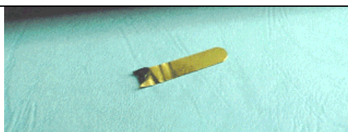
2. Je récupère une languette d'une pile plate de 4,5 V usagée (laiton, épaisseur 0,4 mm)...
