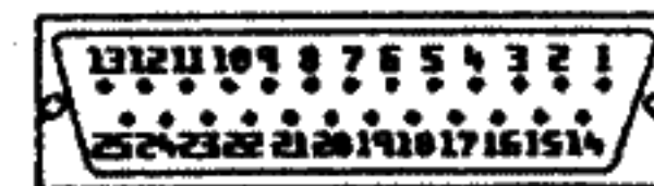
Figure 2: Brochage de la prise RS232 du TELESTRAT (vue de l'extérieur).
