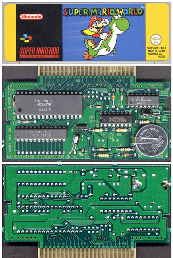
Fig. 19, 20 & 21. La cartouche 'Super Mario World', référence SHVC-1A1B-06 (1990), comporte en U1 'Mask Rom' une Rom LH534J75 (taille inconnue, 32 broches, pas de trous supplémentaires pour Rom de 36 broches), en U2 '16K Sram' une Ram 6116-100 (24 broches), en U3, un circuit 74LS139 (décodeur-démultiplexeur, 16 broches), en U4 'CIC' la 'clef' D413 (sans lettre) Nitendo (1992) et enfin une pile CR2032 de 3V. Evidemment, le circuit imprimé diffère de tout ce que nous avons vu jusqu'ici.
