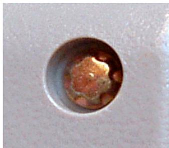
Fig. 5. Gros plan sur la tête d'une vis. Après divers essais, incluant la fabrication d'un tournevis adapté, nous avons opté pour la solution la plus banale : Une pince plate à becs très fins. Il est possible de saisir la vis et de la dévisser délicatement (Fig. 6).
