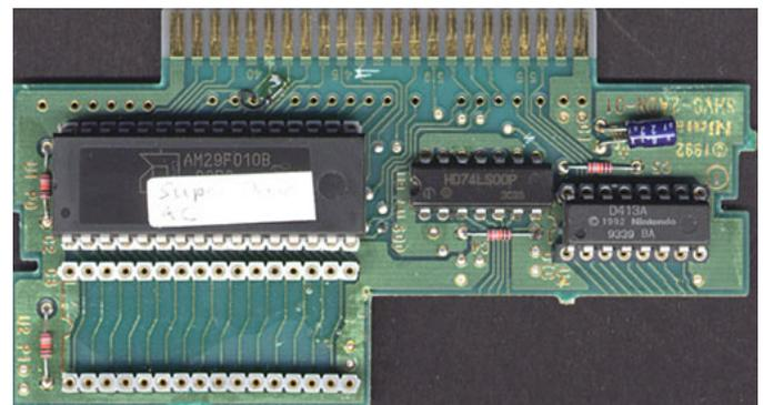
Fig. 2. Le circuit imprimé coté composants avec la mémoire Flash AM29F010B en place. Ce circuit imprimé porte la référence SHVC-2AON-01 (1992) et devait être équipé de deux Roms U1 marquée 'P0' et U2 marquée 'P1' à 32 broches. On peut y voir un circuit logique 74LS00 placé en U4 et une 'clef' Nintendo D413A (1992) placée en U3 'CIC'.
