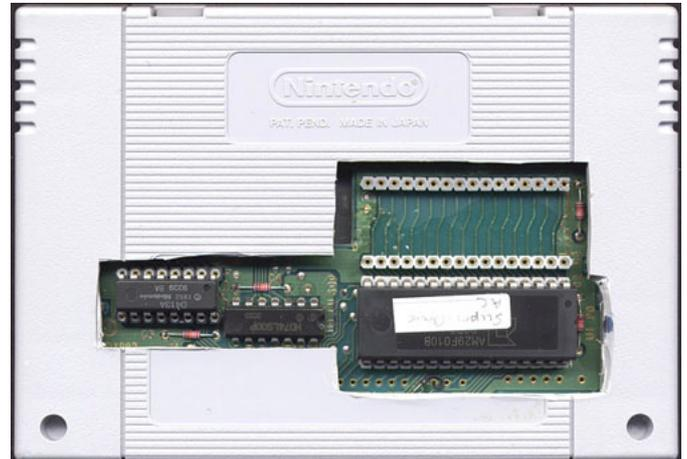
Fig. 1. Voici la cartouche Super-Oric que nous a prêtée Fabrice avec ses composants sur supports de circuits intégrés.
