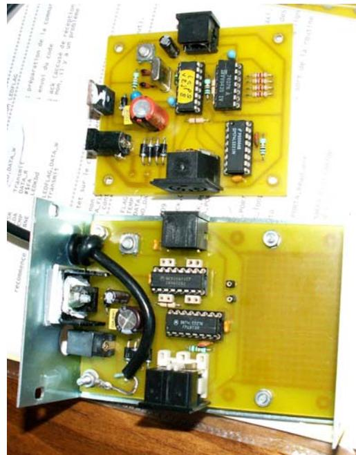
De plus, les masses signaux et châssis ont été séparées afin de minimiser l'influence des parasites extérieurs (téléviseurs rayonnants par exemple...).
