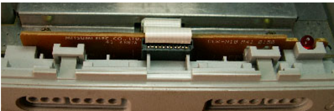
Photo 3 : SNES sans diodes dans le bloc joystick : aucune modification n'est nécessaire pour utiliser l'interface clavier PC - Super-Oric.
