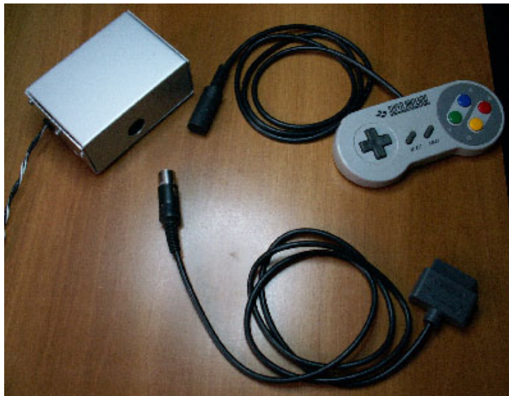
Photo 1 : Utilisation de connecteurs DIN 5 broches pour utilisation manette ou interface clavier.
