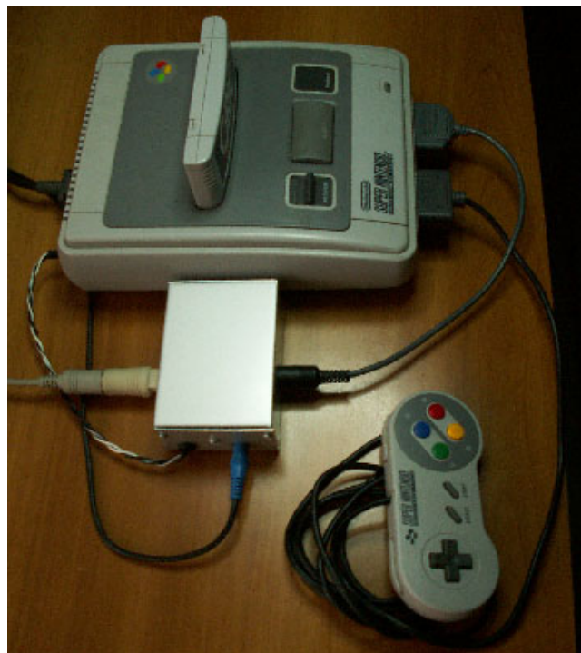
Photo 1 : l'interface clavier PC AT - Super-Oric in situ, et sa mise en coffret.
